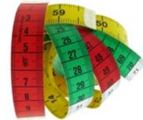
**Cinta métrica:** La cinta métrica es metálica y, aunque es flexible, puede mantener una forma recta. Está graduada en centímetros y en metros.
